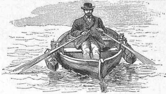
Fig. 1. - Aparato de seguridad inventado por el Sr. Dehnicke, de Berlín, para evitar que los botes zozobren. El bote en su posición normal.
